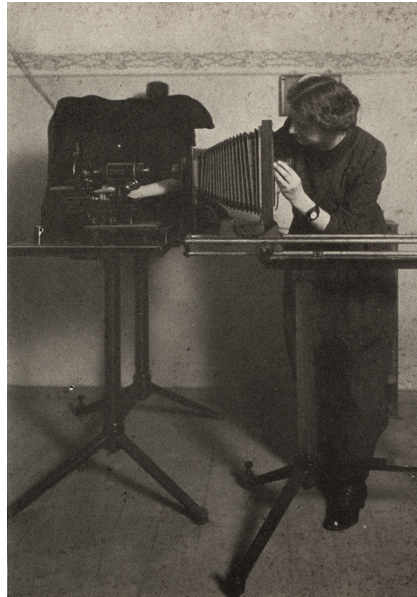
Abb. 5 Anonym: „[...] um alsdann durch Aetzung auf der polierten Fläche mikroskopisch kleine Strukturformen zu erhalten und diese durch den mikroskopischen Apparat bildlich festzulegen (rechtes Bild)“, in: Der Lette-Verein und seine Unterrichtsanstalten, Berlin 1912; Lette Verein Berlin © https://easydb.lette-verein.de/#/detail/1db6db9f-2923-47f6-a9e9-05ce5cb78f03 [09.09.2023].
