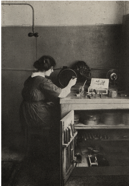
Abb. 4 Anonym: „Die Metallographin erzeugt auf einer Fläche des zu prüfenden Metallstücks mit Hilfe der elektrisch betriebenen Schleifmaschine Hochpolitur (linkes Bild) [...]“, in: Der Lette-Verein und seine Unterrichtsanstalten, Berlin 1912; Lette Verein Berlin © https://easydb.lette-verein.de/#/detail/53fd4f46-510d-4b4f-ac92-f07cc1b46547 [09.09.2023].
